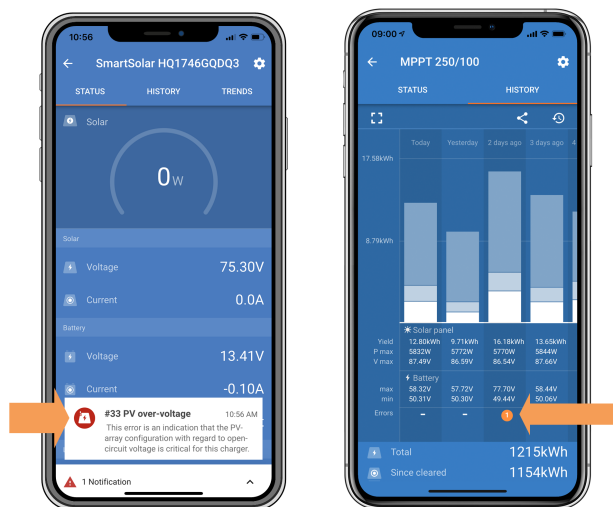
Ein aktiver Fehler und ein historischer Fehler.
