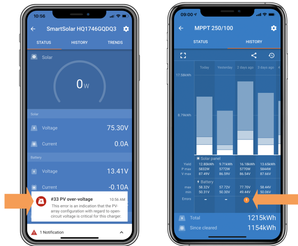
Ein aktiver Fehler und ein historischer Fehler.
