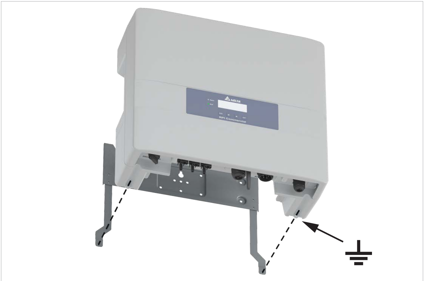
Abb. 4.9: Lage der Montagelöcher und des Erdungsanschlusses am Wechselrichter
