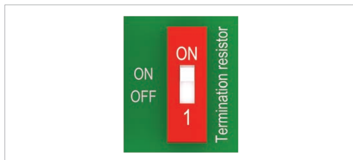
Abb. 6.3: DIP-Schalter für den RS485-Abschlusswiderstand
